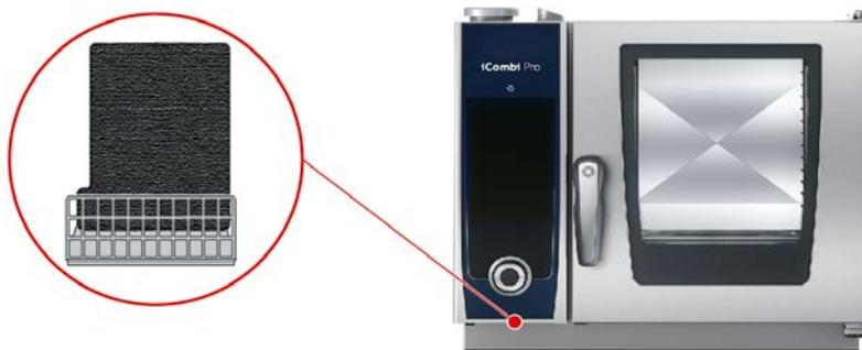
1. Enfoncez le tournevis dans l'encoche du cache du filtre à air et poussez le filtre à air vers l'arrière.
